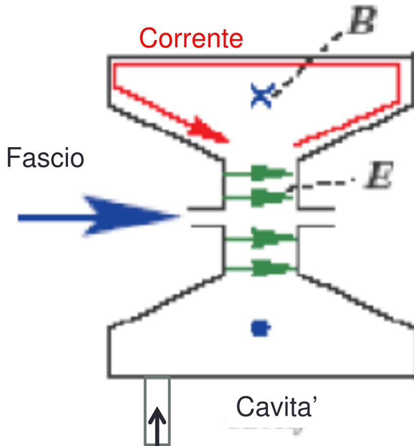
Alta tensione a frequenze radio fornita da generatori tramite condutture speciali (guide d'onda)
