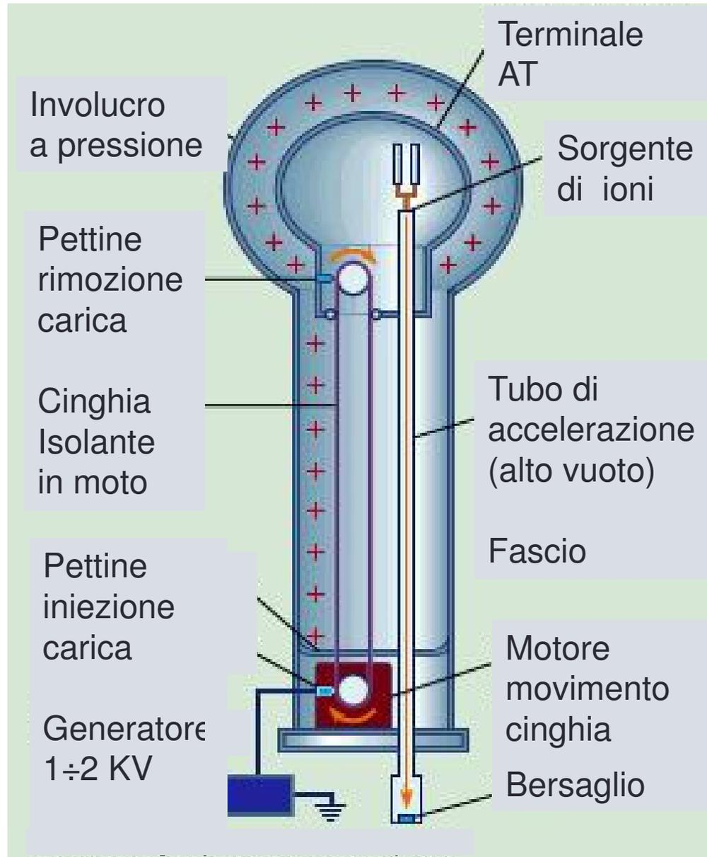
Cinghia isolante in moto caricata/scaricata elettrostaticamente (Strofinio con pettini metallici)
