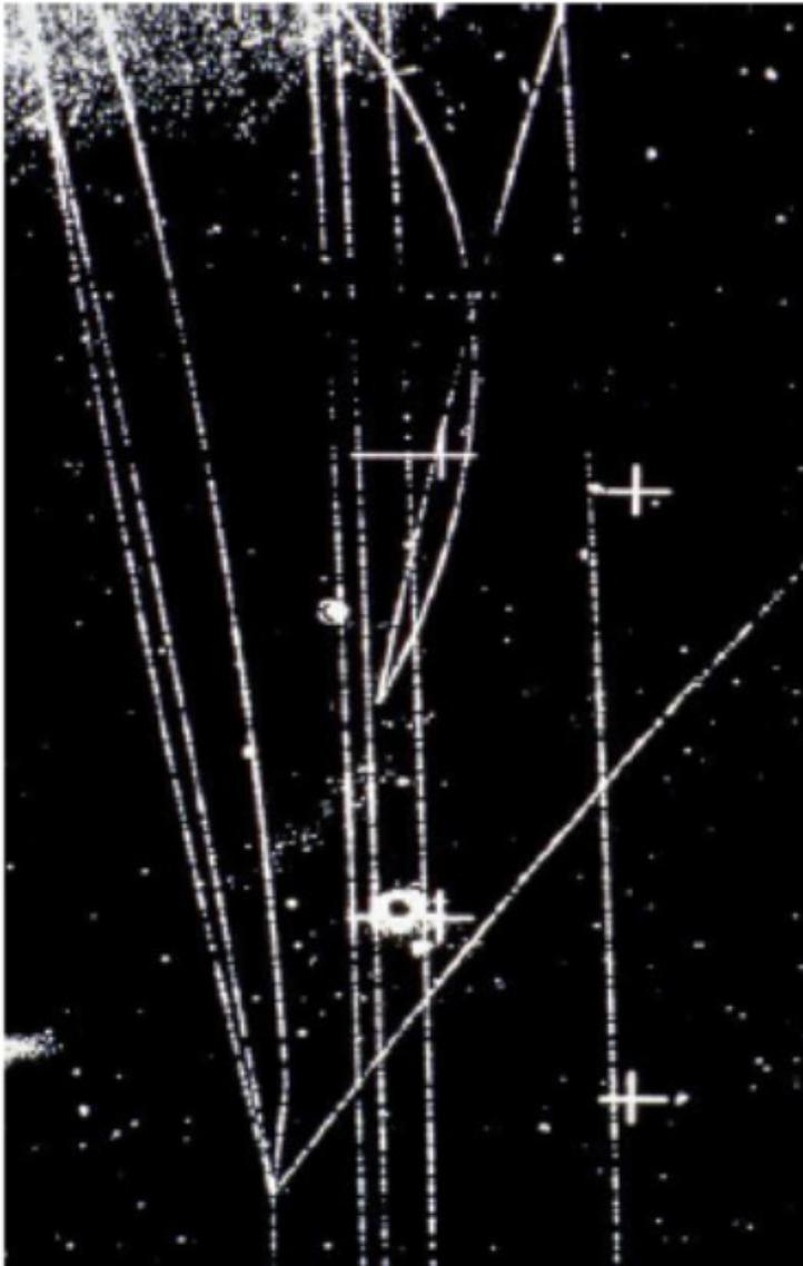
Se il rivelatore visualizzante é immerso in campo magnetico, le traiettorie (tracce) delle particelle cariche non saranno rettilinee, bensì avranno una **curvatura** (dovuta alla forza di Lorentz) il cui raggio dipende dalla **quantità di moto** della particella
