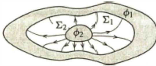
Sistema con induzione completa: Condensatore
