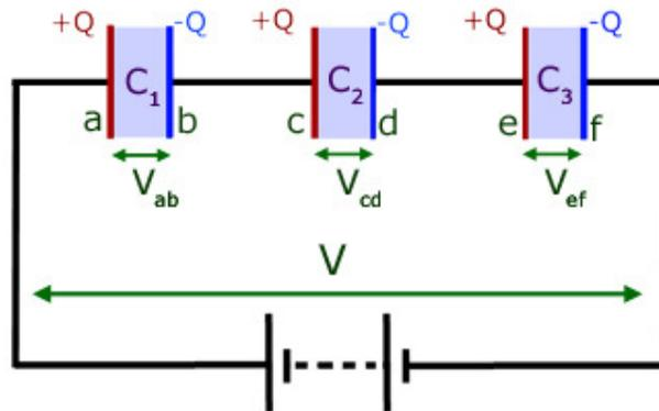
Estensione a  $n$  condensatori in parallelo o in serie
