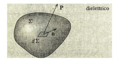
Polarizzazione  $\rightarrow$  Ingresso/Uscita di cariche da V Carica elementare che attraversa l'elemento di superficie  $d\Sigma$ :  $dQ = \mathbf{P} \cdot \hat{\mathbf{n}} d\Sigma$
