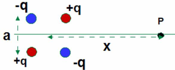
Il campo e' quello di 2 dipoli spostati della distanza  $+a/2$  e  $-a/2$ . Il primo da' sui punti dell'asse x solo la componente y diretta verso il basso, il secondo diretta verso l'alto.
