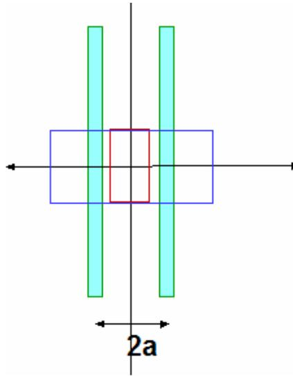
Possiamo applicare il teorema di Gauss usando come superficie gaussiana un cilindro centrato nell'origine, con altezza  $2x$  e area di base  $A$ , come indicato. Il campo elettrico sarà ortogonale ai piani, per ragioni di simmetria: allora il flusso totale di  $\mathbf{E}$  è solo attraverso le basi, e si può scrivere:
