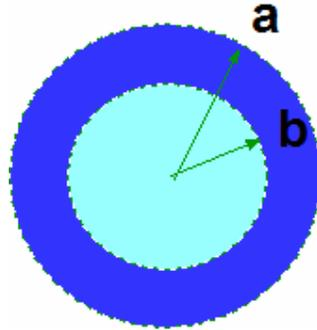
Usiamo il teorema di Gauss, utilizzando come superficie gaussiane sfere di raggio  $r$  concentriche alla distribuzione di carica. A seconda del valore di  $r$  troveremo, per il teorema di Gauss:
