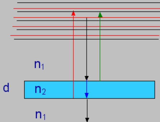
Interferenza fra onda incidente e riflessa dalla faccia superiore della lamina: *divisione di ampiezza* → onda *trasmessa* (parzialmente) nel mezzo trasparente (blu) + onda *riflessa* indietro nel vuoto (verde)
