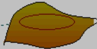
Circuitazione del campo lungo una curva chiusa L che racchiude una superficie S
