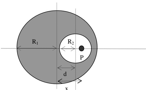
Il filo e' percorso da una corrente  $i$  entrante nel foglio, con densita' di corrente uniforme
