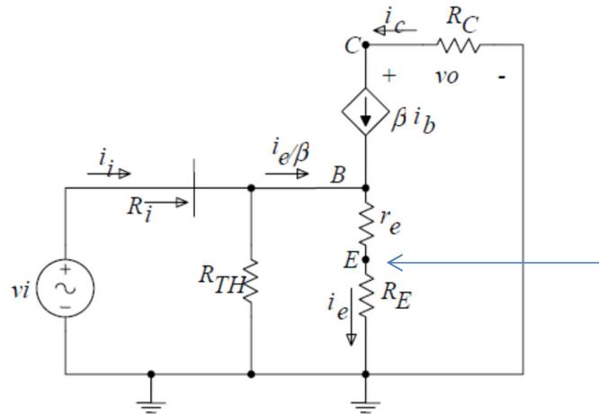
$$R_i = \frac{v_i}{i_i} = R_{TH} \parallel (1 + \beta)(r_e + R_E) \rightarrow \text{Alta: stessa di } CE$$
