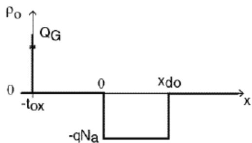
$$\sigma = Q_G \quad x = -t_{ox} \quad \text{carica superficiale sul metallo}$$
