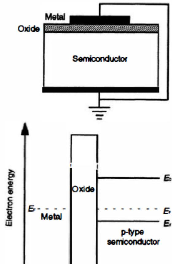
Gap nell'ossido  $\sim 10$  eV  $\gg$  Gap nel semiconduttore
