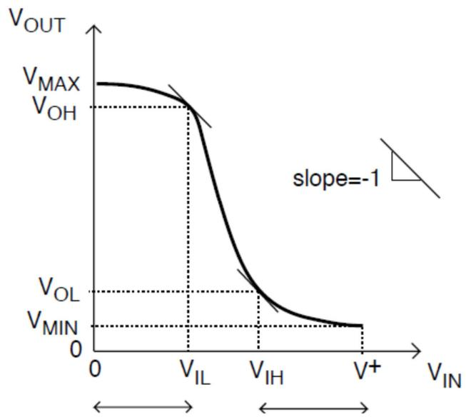
Intervallo di  $V_{in}$  che da'  $V_{out} = 1$       Intervallo di  $V_{in}$  che da'  $V_{out} = 0$
