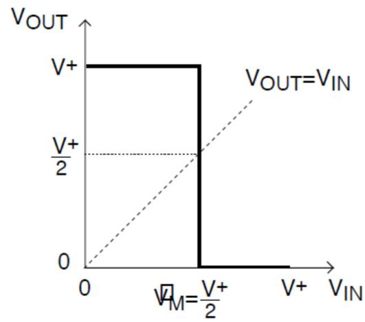
Caratteristica di trasferimento: Inverter reale
