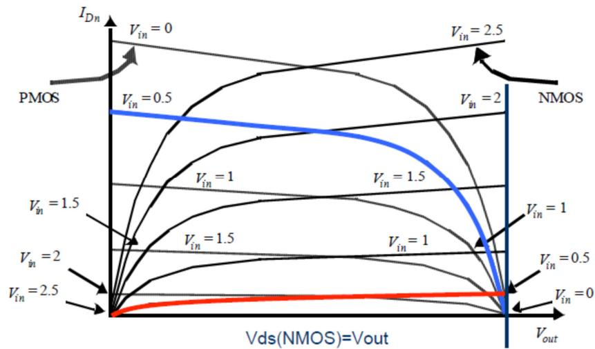
Caratteristiche di uscita per NMOS e PMOS:
