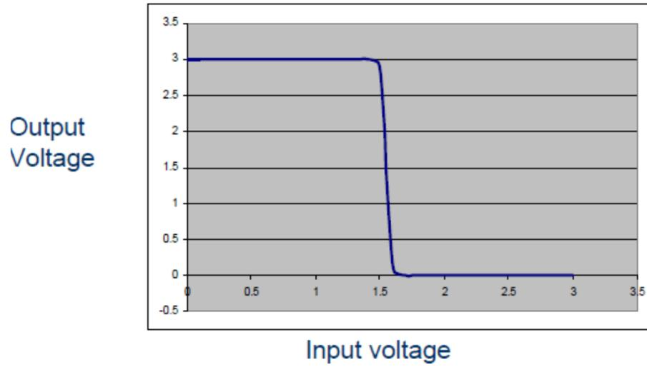
Risposta in/out di un inverter CMOS:
