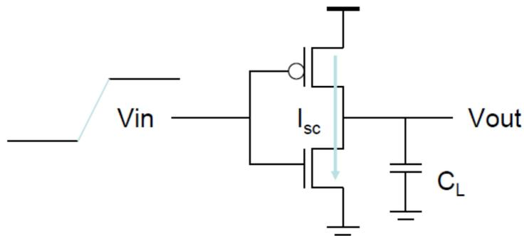
$$i_L = C_L \frac{dv_O}{dt} \text{ corrente nella capacita'}$$
