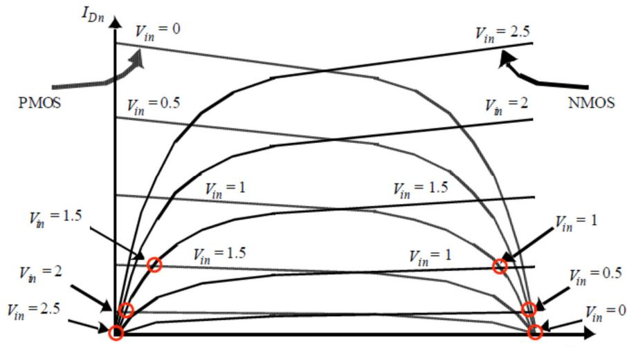
Valori di corrente vs tensione NMOS/PMOS per diversi  $V_{in}$
