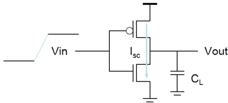
$$i_L = C_L \frac{dv_o}{dt} \text{ corrente nella capacità'}$$
