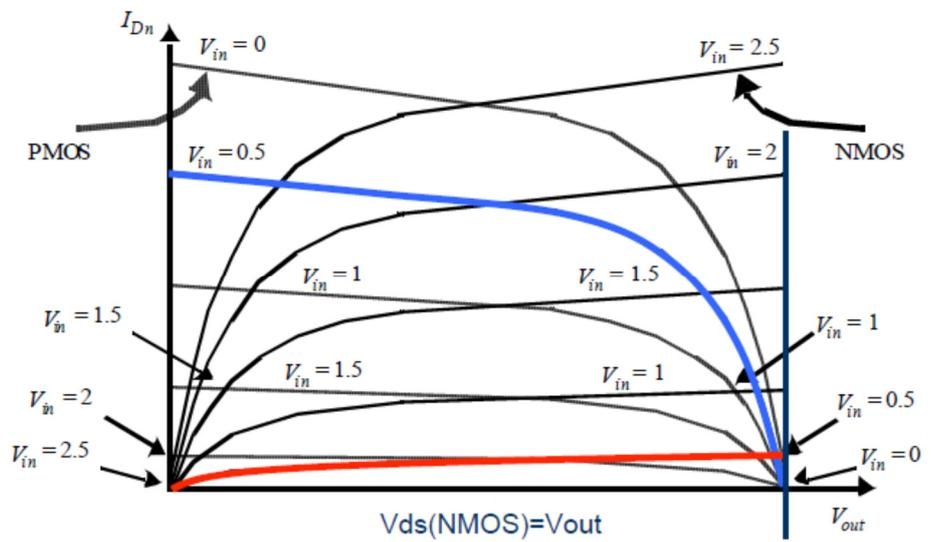
Caratteristiche di uscita per NMOS e PMOS:
