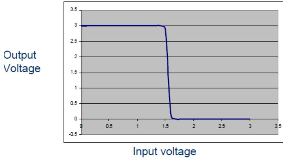
Risposta in/out di un inverter CMOS:
