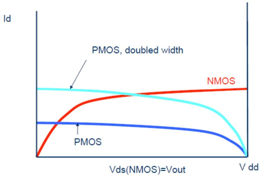
$V_M$  tensione di drain (comune) t.c.  $V_{in} = V_{out}$
