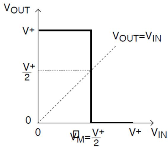
Caratteristica di trasferimento: Inverter reale
