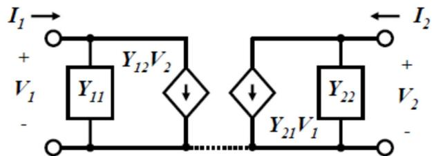
Comparsa di generatori (di tensione e di corrente) *controllati*:
