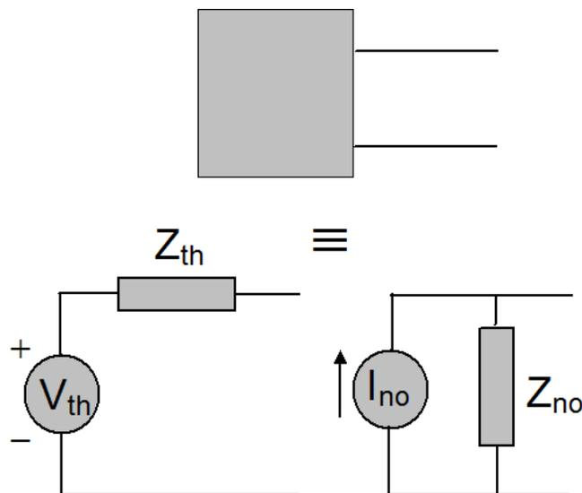
Perche'  $v_{in}$  non conta per il calcolo dell'impedenza di uscita?
