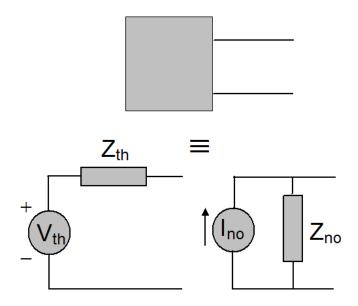
Estensione al caso di reti a 4 terminali (= due porte): Quadripoli Circuiti equivalenti (generalizzazione di Thevenin e Norton): Schemi diversi a seconda dei parametri scelti
