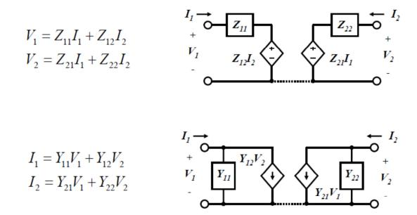
Comparsa di generatori (di tensione e di corrente) *controllati*: il valore di tensione/corrente e' fissato dal valore di un'altra tensione/corrente
