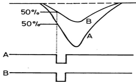
Oltre al *walk c'* è anche un *jitter* intrinseco alla natura fisica del segnale e al rumore del preamplificatore: dipende dalla pendenza del fronte di salita in ingresso.
