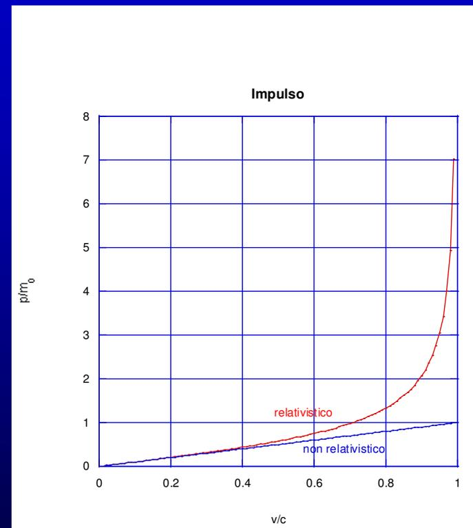
Notare la divergenza per  $\beta \rightarrow 1$ : una particella con velocità uguale a quella della luce avrebbe massa e quantità di moto infinite
