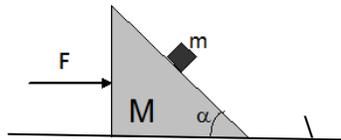
1. Determinare il minimo e massimo valore della forza  $F$  che si deve applicare al corpo di massa  $m$  perche' resti immobile rispetto al blocco, se  $F$  viene applicata con un angolo  $\beta = 30^\circ$  rispetto al piano inclinato e il blocco viene fissato al pavimento
