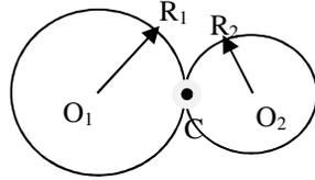
Nel punto di contatto  $C$  si muovono solidamente e senza strisciare. Inizialmente la ruota di raggio  $R_1$ , partendo da ferma, viene posta in moto con accelerazione costante  $\alpha_1 = 2 \text{ rad/s}^2$ .
