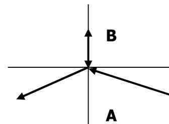
Componenti della velocità delle sfere:
